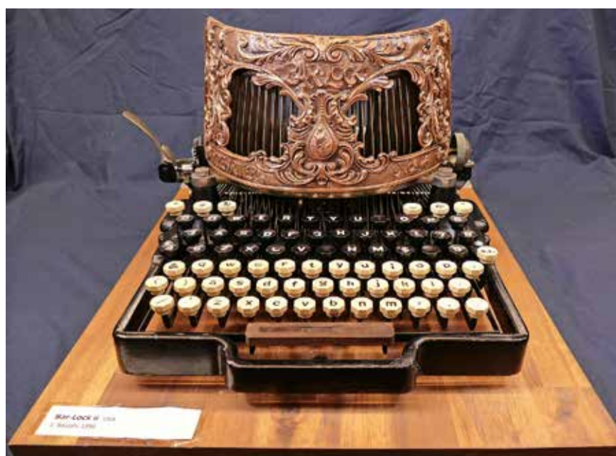
Bar-Lock 6, Volltastaturmaschine mit Oberaufschlag, 1. Baujahr 1896 in den USA.
